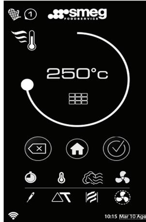
En touchant l'icône « delta T » (devient jaune), la valeur souhaitée est réglée. La valeur minimale est de 20°C et la maximale de 60°C, qui peuvent être réglables par étapes de 1°C.
