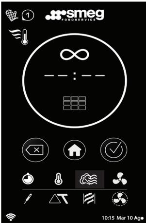
En touchant l'icône ∞ (devient jaune), vous désactivez le défilement et le clavier et réglez l'heure à l'infini.
